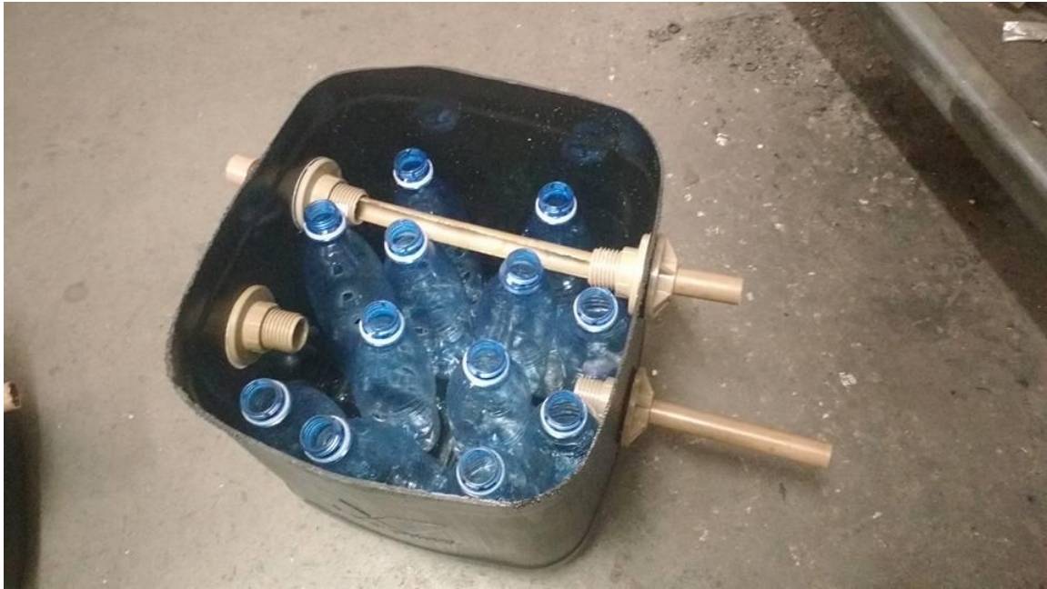
Figura 3. Placa coalescente formada por garradas PET.
